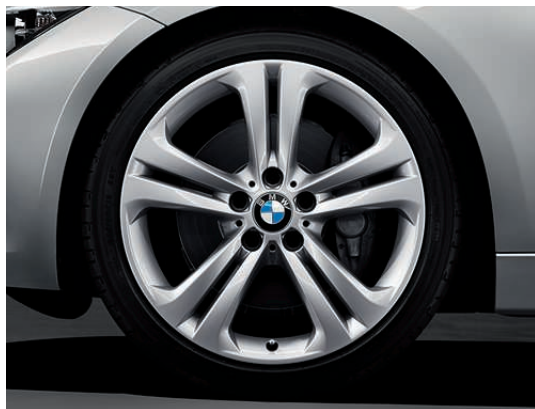
□ 19" Leichtmetallräder Doppelspeiche 401 mit Mischbereifung, vorn 8 J x 19, Bereifung 225/40 R 19, hinten 8,5 J x 19, Bereifung 255/35 R 19.
